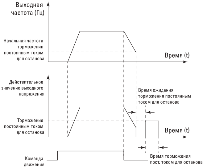
Рис. 6-13. Схема торможения постоянным током для останова
