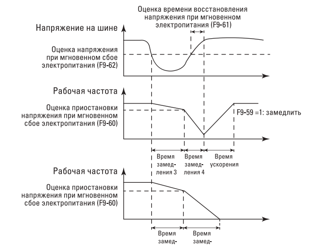
Рис. 6-25. Схема действия при мгновенном сбое электропитания
