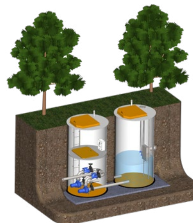
Рисунок 6. КНС с погружными насосами сухой установки и двумя камерами (мокрая/сухая).
