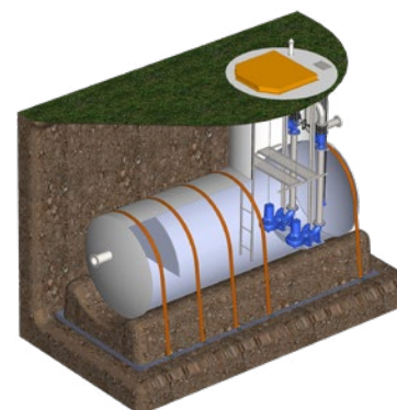
Рисунок 5. КНС в горизонтальном корпусе.
