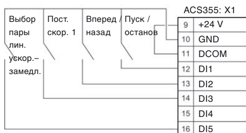
Конфигурация цифровых входов (DI) (подключение PNP) (приемник)
