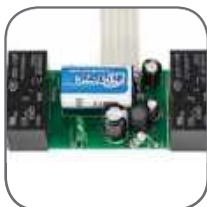
Два встроенных реле на токи до 16 А
