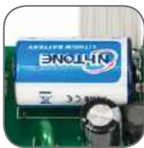
Часы реального времени работают 10 лет без питания
